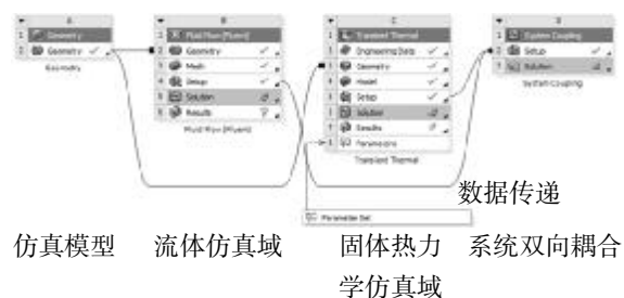
图 3 流固双向耦合仿真结构
